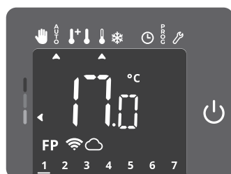
Fil pilote = Éco - 2 Confort - 2°C
